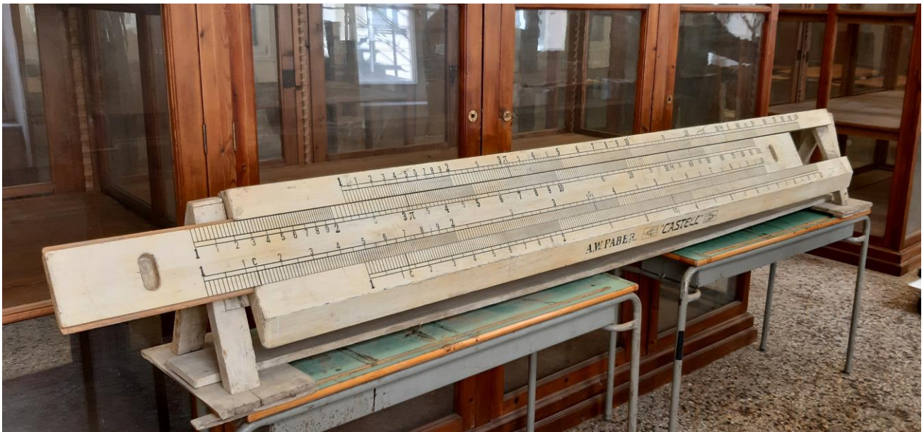
Ξύλινο λειτουργικό υπόδειγμα λογαριθμικού κανόνα της εταιρίας Faber Castell.
